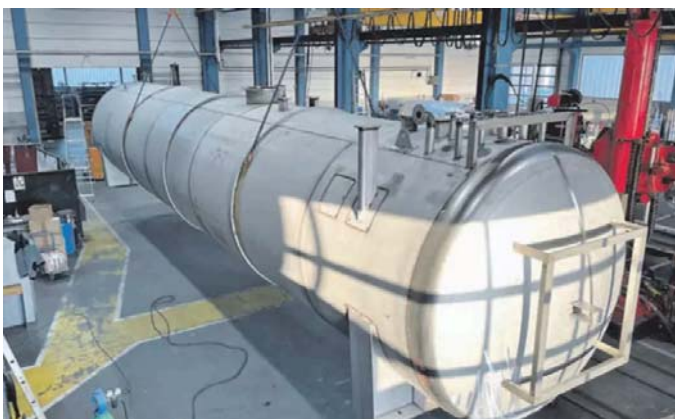
Doppelmantel-Lagertank 100 m 3 (mit Leckageüberwachung) für Biotreibstoffe, Aufstellort Niederösterreich
