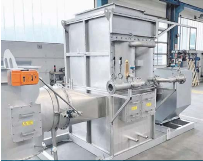
2 Stk. werkseitig vormontierte WRG-Anlagen für einen Glühetrieb sorgen für minimale Montagedauer während des Betriebsstillstandes
