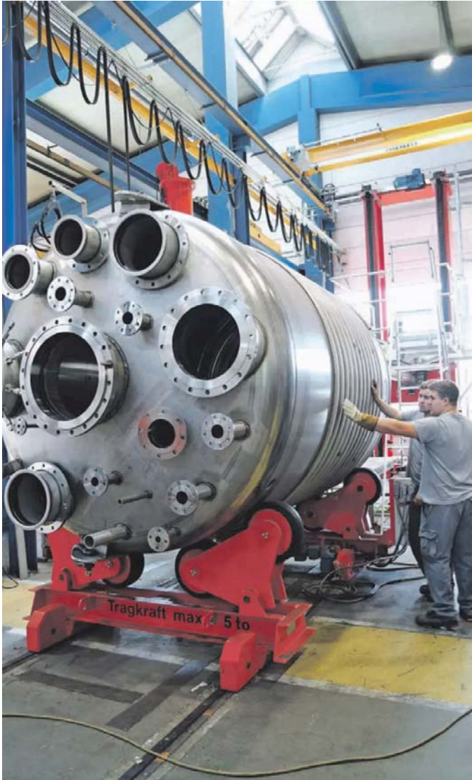
Mit Halbrohrschlangen beheizter Rührwerksreaktor für die Farbenherstellung, Aufstellort Wels
